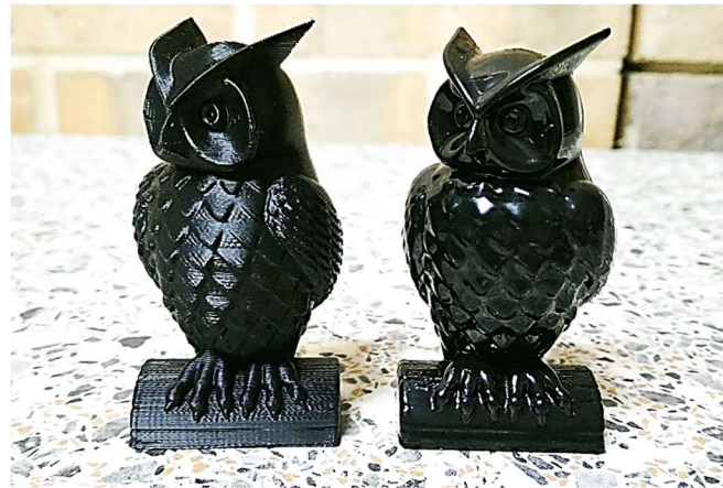
Figura 1 – Objetos impressos a 3D antes e depois da fase de acabamentos ou pós-processamento
