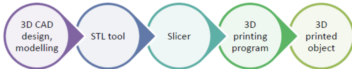
Abbildung 9 3D Druck Arbeitsprozess
