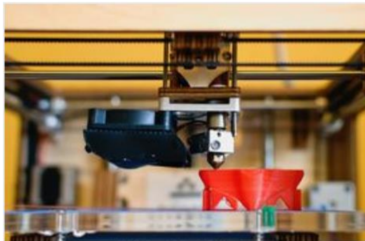
Abbildung 2 3D Druck von einem Polymer-Teil
