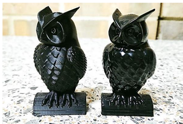
Abbildung 3 3D gedrucktes Objekt vor und nach der Nachbearbeitung
