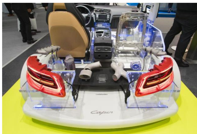
Abbildung 5 Teile der Fahrzeugtechnik hergestellt über 3D-Druckverfahren
