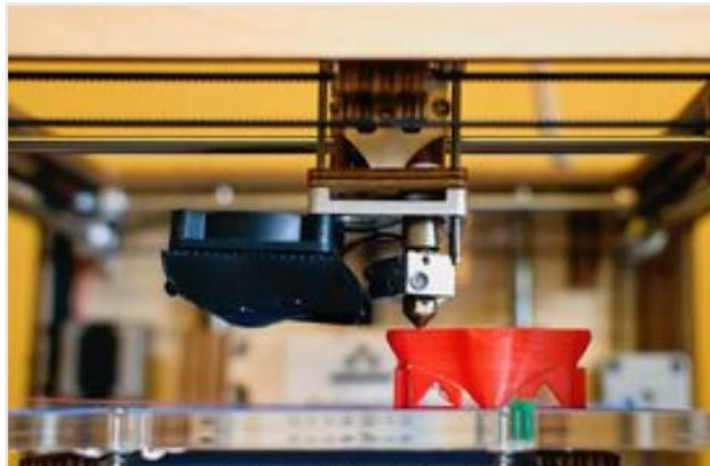
Imagen 2 – Impresión 3D de una pieza polimérica
