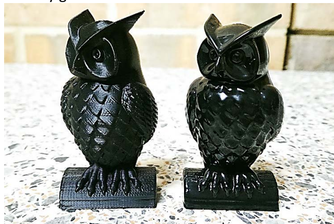
Imagen 3 – Objeto impreso en 3D antes y después de ser procesado posteriormente..
