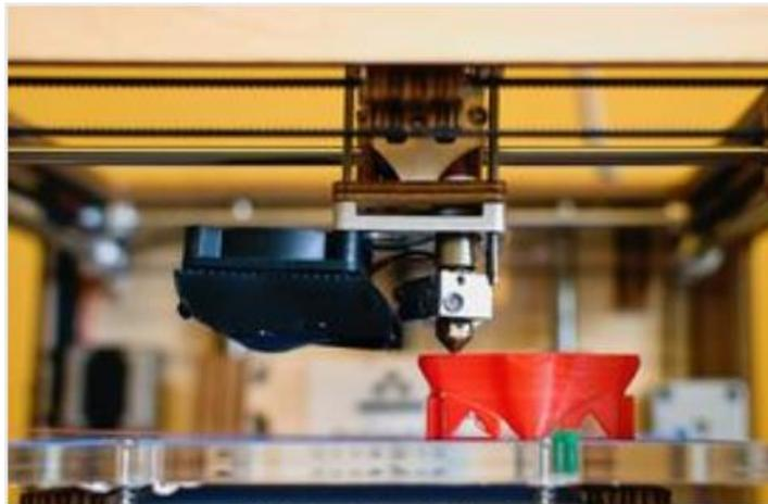
**Imagen 2 – Impresión 3D de una pieza polimérica**
