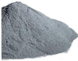
de cobalto y cromo Co28Cr6Mo (resistencia a la tracción a 1300 MPa), aleación de aluminio AlSi10Mg (resistencia a la tracción 445 MPa), oro y plata.
